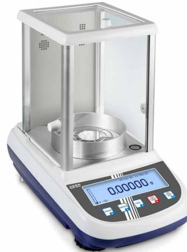
**KERN ALJ 200-5DA** con ionizzatore opzionale ■, vedere *Accessori*. Bilancia analitica semimicro di alta precisione. L'alta precisione la rende adatta per calibrare le pipette.
