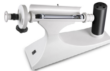
Cubeta en la cámara de medición.
