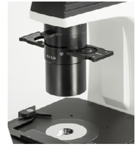
N.A. 0,3 Abbe Condenser with phase contrast slide
